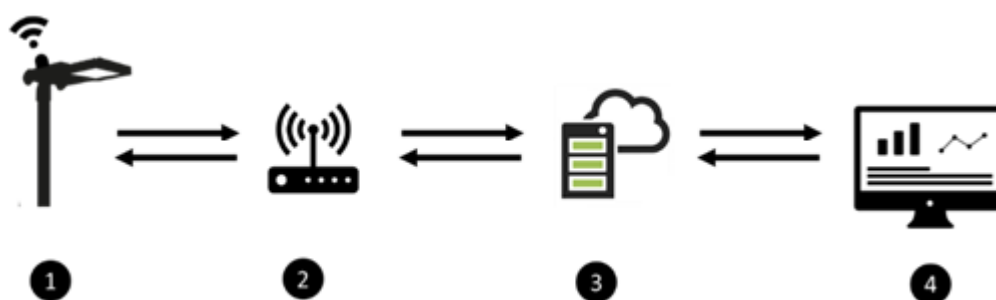
Figura 10 – Estrutura operacional do Sistema de Telegestão
